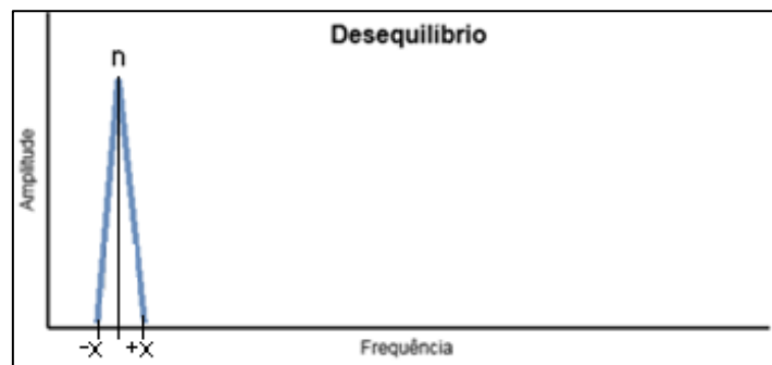
Figura 32 – Representação esquemática de FFT de um defeito de desequilíbrio [86]
