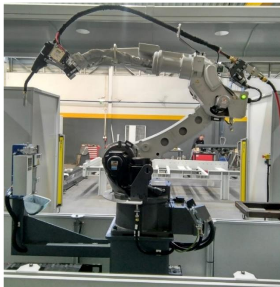
Figura 3.6: Manipulador Panasonic TM-1800 posicionado na máquina.
