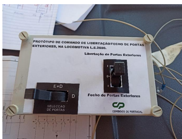
Figura 4.31 – Teste dos seletores de comando de libertação e fecho de portas
