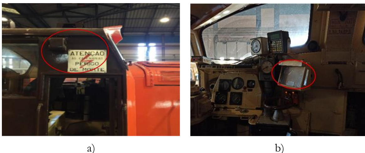
Figura 3.4 – Perspetiva da LD 1400: a) localização exterior das câmaras; b) localização interior dos displays LCD
