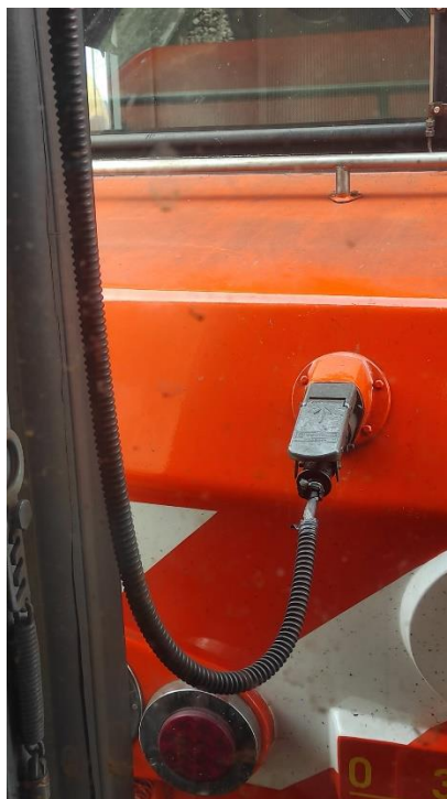
Figura 4.12 – Acoplamento do cabo atual UIC 558 para a carruagem
