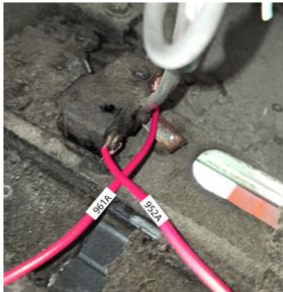
Figura 4.24 – Ligação do micro interruptor da porta à UCP
