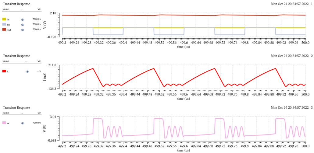
Figura 3.14: Resposta do circuito BOOST a uma tensão de 700mV. No primeiro gráfico: tensão retificada a castanho, sinal de relógio a cinzento e tensão de saída a amarelo. No segundo gráfico: a corrente na bobina do conversor. No terceiro gráfico: tensão entre o mosfet e o diódo, Vx.
