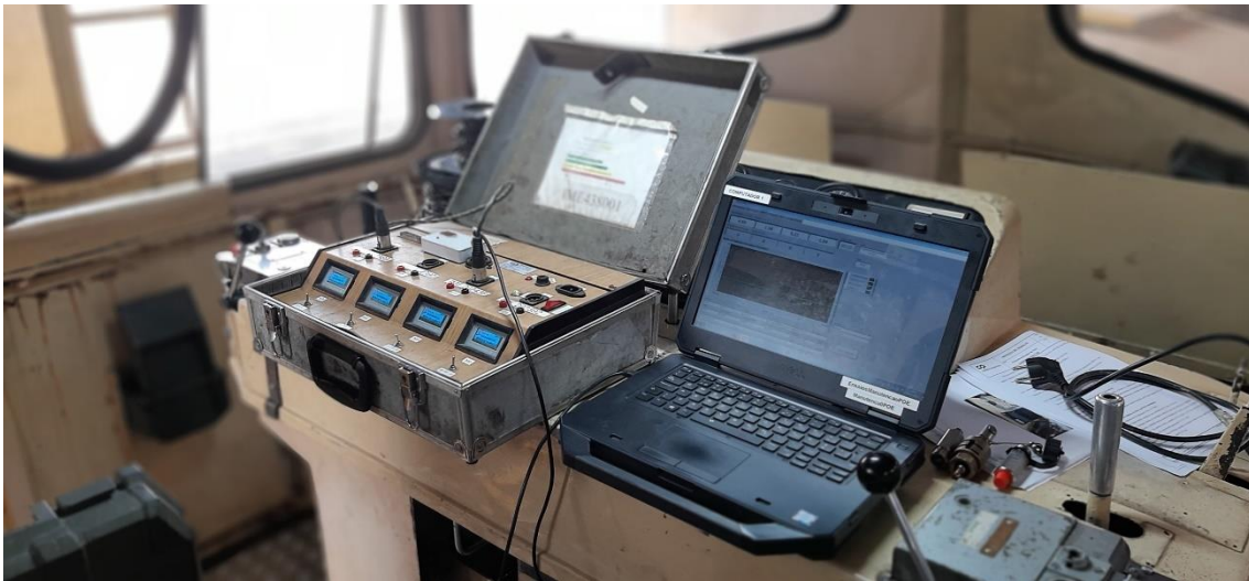
Figura 37 - “Mala” de ensaios e computador portátil para registo de ensaios de freio
