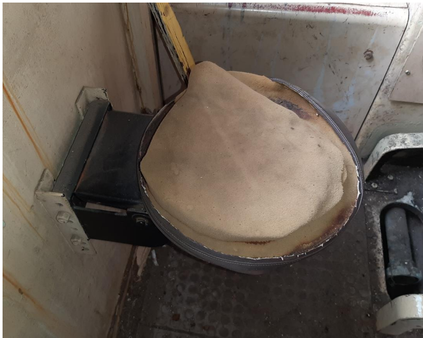
Figura 48 - Bancos de condução antes de serem recuperados.
