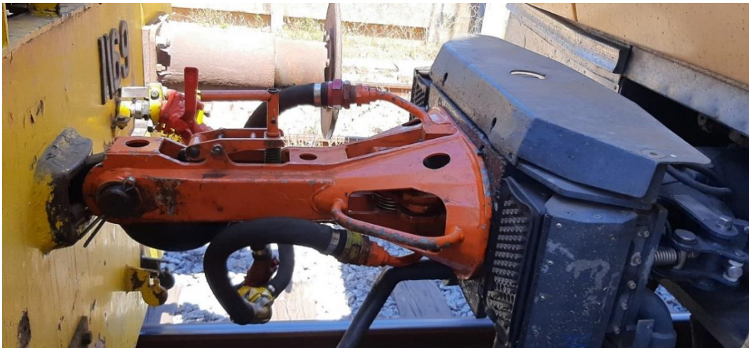
Figura 39 - Engate de transição com os acoplamentos da CG e CP.
