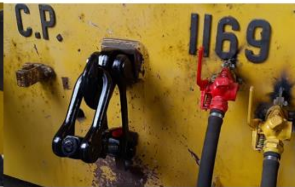
Figura 42 - Gancho e tensor de engate.
