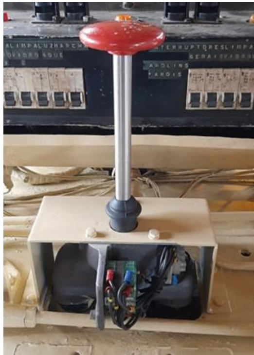
Figura 10 - Válvula de emergência do Tipo SBV1 (válvula de murro).
