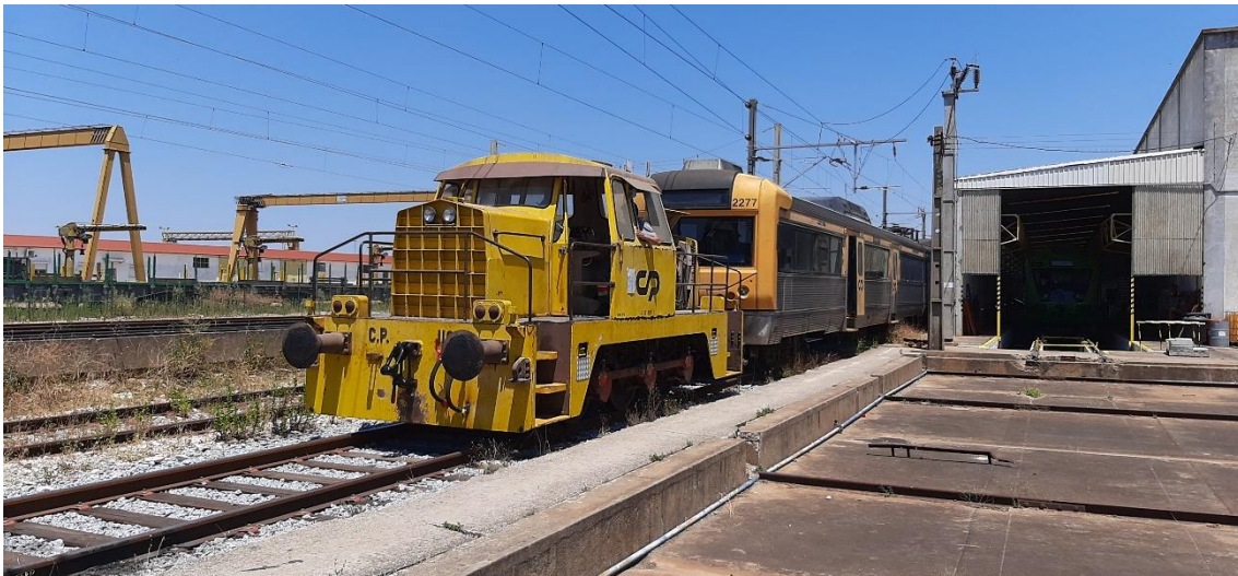
Figura 40 - Locotrator Sentinel à velocidade de 10 Km/h com a UTE 2277 a reboque
