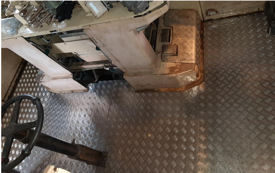
Figura 47 - Chão da cabina de condução após substituição.
