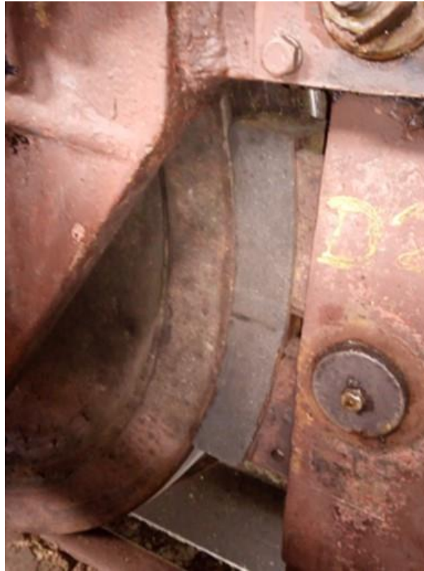
Figura 24 - Guarnições (Cepo) locomotora Sentinel.
