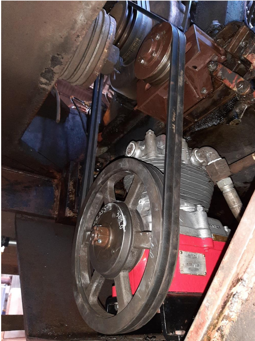
Figura VII.4 - Compressor A800 com a polia e as correias trapezoidais dimensionadas
