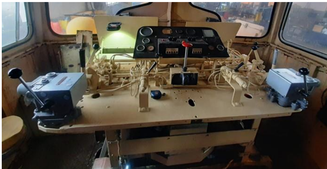
Figura 15 - Cabina de condução do locotrator Sentinel, após modificação.
